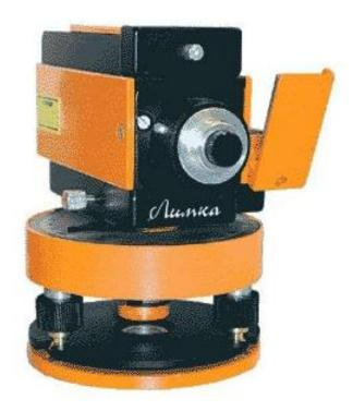
Простой в использовании лазерный проекционный нивелир с компенсатором. Задает горизонтальный и вертикальный луч (только с использованием пентапризмы (90°)). Компенсатор обеспечивает установку прибора в горизонтальной плоскости. Наличие лимба дает возможность разметки горизонтальных углов.
